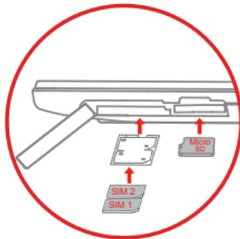
**步骤 2.** 取出卡座，将SIM卡金属触点面朝上，截角朝外置入卡座，再将卡座插回卡插槽中。
