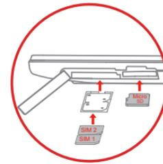
步骤 2. 取出卡座，将SIM卡金属触点面朝上，截角朝外置入卡座，再将卡座插回卡插槽中。将MicroSD卡金属触点面朝上插入卡插槽内。
