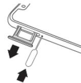
如下图所示，对准 SIM 卡和卡槽的缺角位置，将 SIM 卡和存储卡的金属面朝下放入卡槽。
