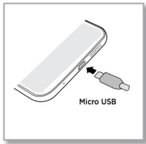
为手机充电时，请将手机随附的数据线小端插入充电端口（请参阅[手机外观](#)查看端口位置），将另一端插入电源插座。
