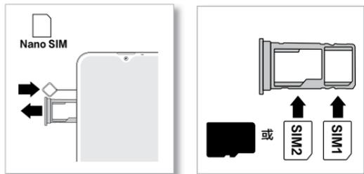
1. 将取卡针插入卡托孔，向内轻按，弹出卡托。
