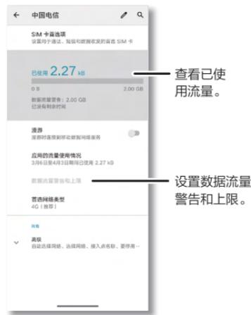
某些应用在您不查看时仍会在后台传输数据。为减少此类数据流量的使用，向上滑动 **^** > **设置** > **网络和互联网** > **高级** > **流量节省程序** > **应用联网管理**，禁止某些应用在后台连网。
