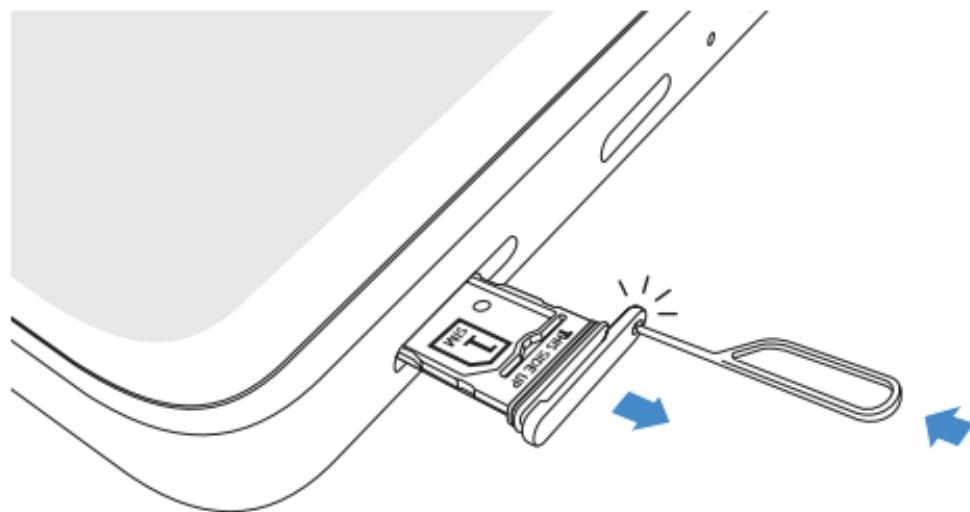
1 手机屏幕朝上，将取卡针插入手机底部的卡托孔，向内轻按，弹出卡托。
