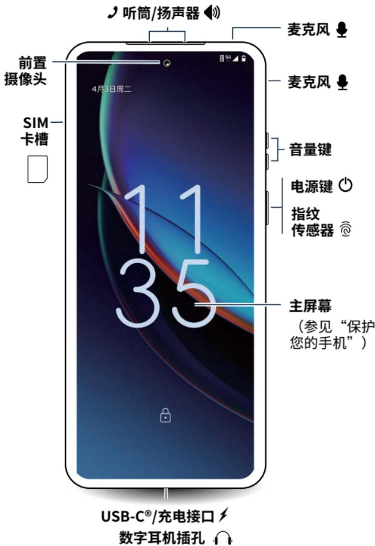
**提示：**仅支持 USB-C 接口的数字耳机。使用耳机时，请将接口插入 USB-C 充电/耳机接口中。如需使用 3.5mm 接口的数字耳机，请单独购买 Type-C 转 3.5mm 数字音频数据线。耳机和音频数据线可能需要单独购买。
