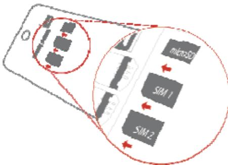
注：联通 WCDMA 卡需插在 SIM1 卡槽才能识别到 3G 网络，SIM2 卡槽只能识别到移动或联通的 2G 网络
