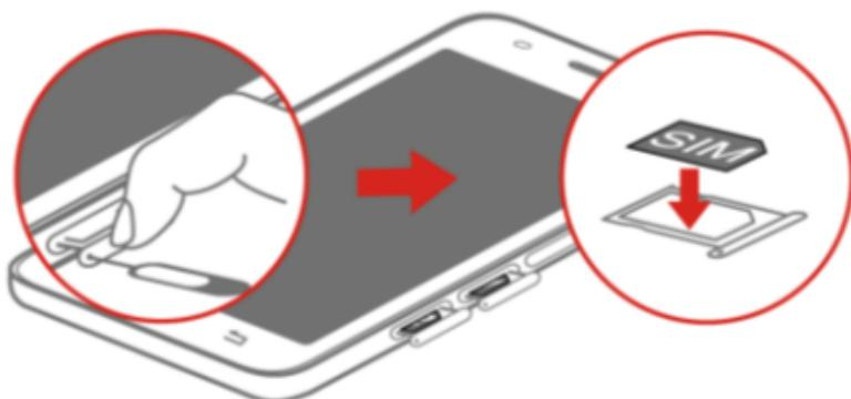
2. 用取卡针将存储卡槽取出，将存储卡放入卡槽(您可能需要额外购买存储卡)，如下图所示。
