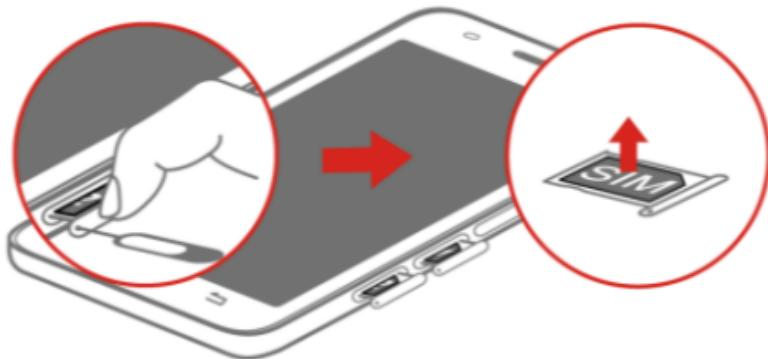
3. 用取卡针将存储卡槽取出，并将存储卡从卡槽中取出，如下图所示。
