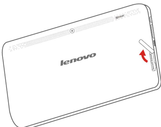
2. 按照如图所示方向插入Micro SIM卡和microSD卡。
