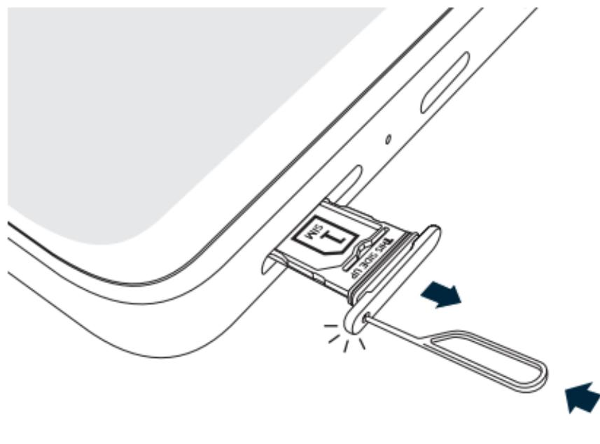
2 将 Nano SIM 卡金属面朝上，对准卡托上图示的缺角位置，放入卡槽后，将卡托小心推回手机。卡托背面可以放入第二张 Nano SIM 卡。
