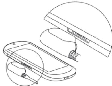
(7) 将 USB 数据线的另一端插入旅行充电插头，然后将旅行充电插头插入电源插座。或者直接将 USB 数据线插入电脑的 USB 口进行充电。
