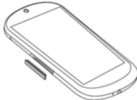
(6) 将 USB 数据线的主机接头吸附在电源数据端口上。
