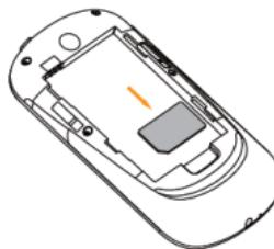
(3) 将电池的铜片部位对准电池槽的金属接触点，轻轻将电池推入。
