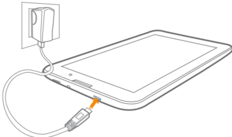
电池电量低于一定电量时，IdeaTab会发出提示音，并且电池状态图标会变成
