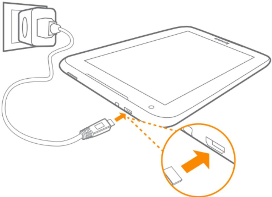
电池电量低于一定电量时，Lenovo A1000L会发出提示音，并且电池状态图标会变成
