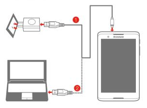
方法 1. 使用附带的数据线和电源适配器将您的Lenovo A3300-T连接至电源插座。
